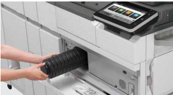
Sostituzione delle cartucce toner senza interrompere il ciclo di stampa/copiatura.
